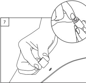
**Verbleibende zwei Distanzhülsen (4) mit beigelegten Klebepads (5) versehen und an die Rückseite des Briefkastens auf die oberen zwei Befestigungslöcher kleben / Stick the spacer sleeves (4) with the provided adhesive pads (5) to the back of the mailbox to the 2 mounting holes above**
