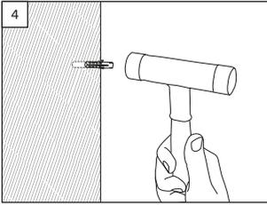
**Dübel (2) in die gebohrten Löcher stecken /**
