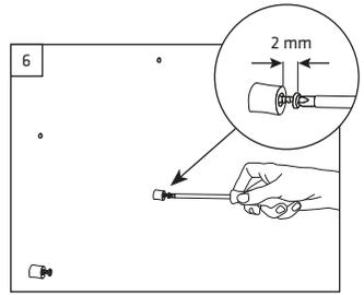
**Die Schrauben aus Schritt 5 in die entsprechenden Dübel stecken und und mittels Schraubendreher locker eindrehen, dabei ca. 2 mm Abstand zur Wand lassen / Die Schrauben aus Schritt 5 in die entsprechenden Dübel stecken und und mittels Schraubendreher locker eindrehen, dabei ca. 2 mm Abstand zur Wand lassen**
