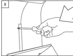
**(Zuerst das Zeitungsfach und dann) den Briefkasten einhängen und diesen mittels Schraubendreher an die Wand festschrauben. Verwenden Sie dazu für die oberen Befestigungslöcher je eine Schraube. / First of all hang up the newspaper holder and then the mailbox, screw tight with the screw driver to the wall. Therefore, use one screw for each mounting hole above.**
