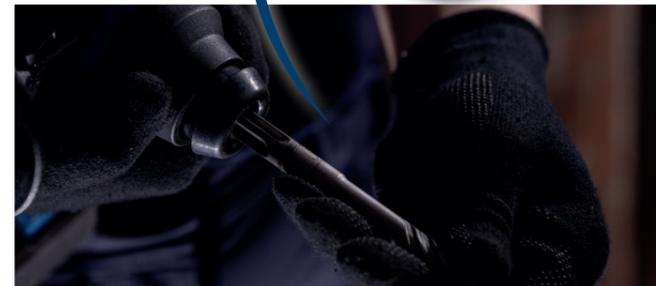
Das SDS-Plus-Bohrfutter ermöglicht einen werkzeuglosen Bohrer-Wechsel.
