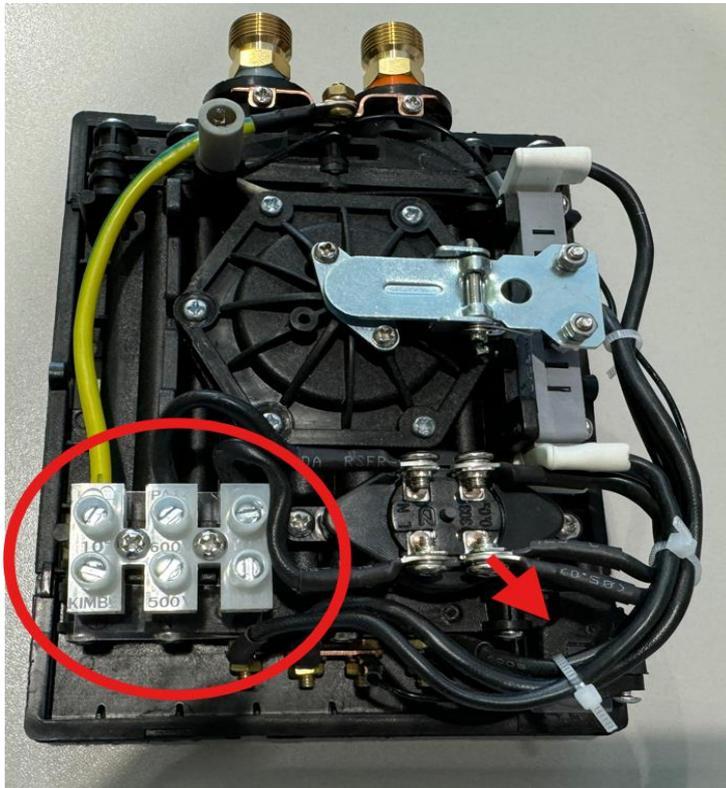
4. Schließen Sie das separat erworbene Anschlusskabel entsprechend der Beschriftung innerhalb des Anschlussblocks an und drehen die Schrauben fest an:
