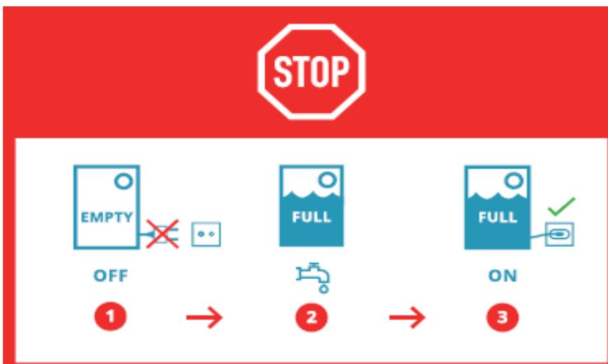
2. Stellen Sie den Wasseranschluss her und prüfen die Dichtigkeit. Nach dem Befüllen und vollständigen Entlüften des Gerätes können Sie den Elektroanschluss vornehmen.
