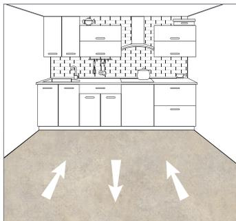
Für die meisten großformatigen Designs sollten die Platten abwechselnd in entgegengesetzter Richtung verlegt werden. Lesen Sie vor dem Beginn der Verlegearbeiten die Designspezifikationen.
