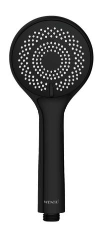
Ahorra un 40% de agua manteniendo total comodidad. Los modelos con "WaterSaving System" están diseñados para consumir menos de 8 litros/ minuto\* (\* a 3 bares de presión de agua) con ayuda de un inserto para el ahorro de agua., que mantiene el flujo constante. Conexión universal ½". Adecuada para calentador continuo de agua. De larga duración, con boquillas para una fácil limpieza de la cal. Pulse el botón para cambiar de función. Cabezal con 3 funciones.
