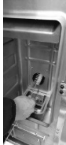
Fig. 40 - Limpieza con escobilla
