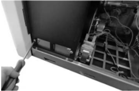
Fig. 82 - Limpieza ventilador ambiente (Atena³ Plus 12/14 - Duke 12/14 At - Saba 12/14)
