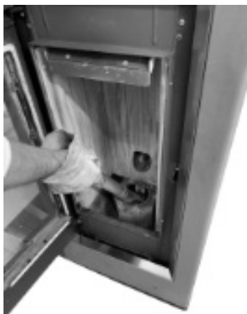
Fig. 33 - Limpieza alojamiento brasero
