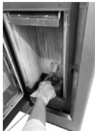
Fig. 34 - Limpieza con escobilla
