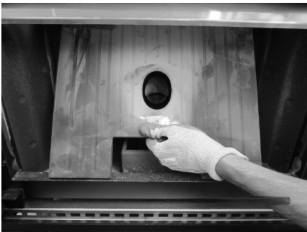
Fig. 34 - Extracción de la pared central de hierro fundido
