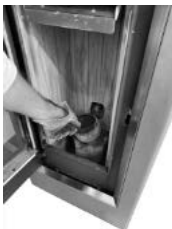
Fig. 33 - Extracción del brasero
