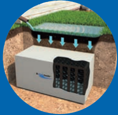
Regenwasserversickerung über Dachrinnenabfluss
