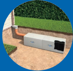
Entwässerung über Dachrinne mit Regensinkkasten
