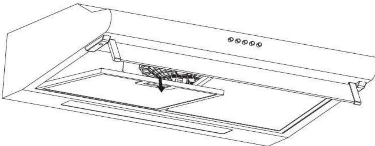
3. Lampe durch Drehung nach links herausdrehen.
