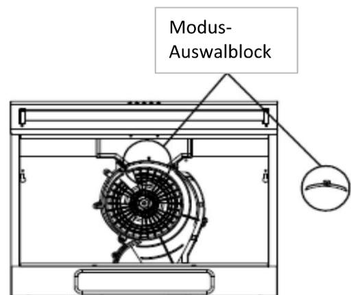
Dann montieren Sie den Kohlefilter, indem Sie ihn an die Filteraufnahme unten am Motor führen und durch Rechtsdrehung fest montieren. (Bajonettverschluss)
