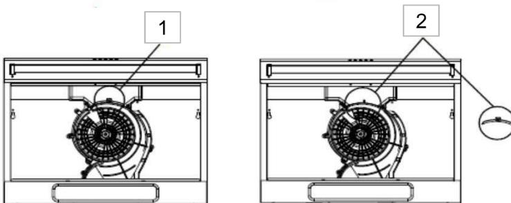
Für Abluftbetrieb den Modus-Auswahlblock (**Abb. 1**) nicht entfernen.
