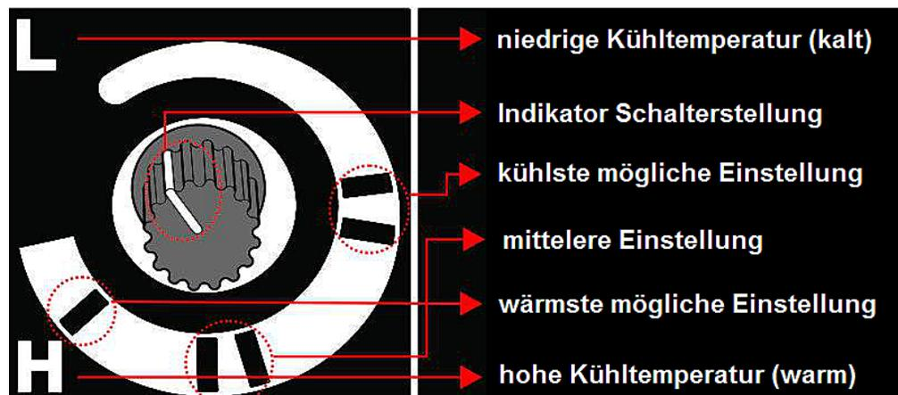
6. Lokalisierung der Einstellung hinten am Gerät.
