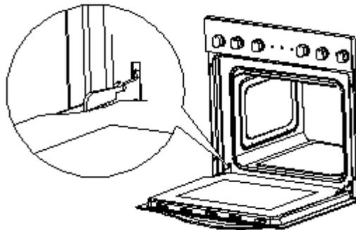
7. Falls der Sicherheitsbügel nicht ordnungsgemäß geschlossen ist, wird das Scharnier beim Schließen der Tür beschädigt.
