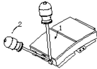
Anschlussdose öffnen: Zum Entriegeln Schraubenzieher ansetzen (1) und leicht nach unten bewegen (2).
