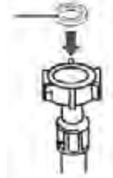
2. Befestigen Sie das **gerade** Ende des Wasserzulaufschlauchs an dem entsprechenden Wasseranschluss (s. Abb. rechts).
