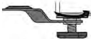
3. Drehen Sie zur waagerechten Ausrichtung des Gerätes die verstellbaren Standfüße.
