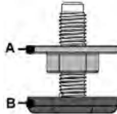
a. **Lösen** der Kontermutter: mit dem Schraubenschlüssel **nach links** drehen (s. Abb. rechts).
