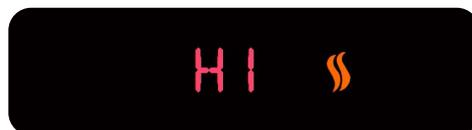
**NOTA:** EN EL AJUSTE H2 EL CALEFACTOR FUNCIONARÁ CONTINUAMENTE A 2000W, EN EL AJUSTE H1 EL CALEFACTOR FUNCIONARÁ CONTINUAMENTE A 1000W. SIN TERMOSTATO DE TEMPERATURA AJUSTADO.
