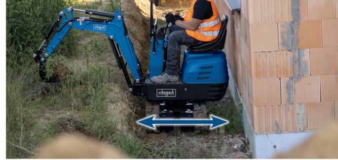
Dank einer hohen Grabreichweite von maximal 2330 mm können auch Arbeiten an Böschungen oder Schrägen optimal ausgeführt werden.
