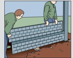
Motivplatten entsprechend der passenden Seite in die Pfostennut einsetzen und weiter verkleben. (Bei dem Motiv Nostalgie Z-Versatz beachten, bei Klassik-Stein A und B Seite im Wechsel einsetzen)
