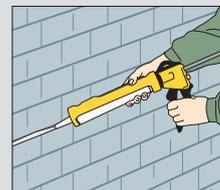
Für eine blickdichte und einheitliche geschlossene Optik werden die Zwischenräume der Plattenelemente, Oberlatten und Kappen mit Außenacryl versiegelt. Erforderliche Außentemperatur beträgt ca. 14°C.
