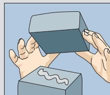
Pfostenkappen und Oberlatten mit Flexkleber montieren. In den Ecken (Eckpfostenkappen) werden immer die Oberlatten zurechtgeschnitten. Zum Abschluss des Rohbaus Zaunelemente reinigen.
