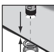
A csap és lefolyó területén a feszültség okozta repedések elkerülése érdekében ajánlott megfelelő tömítőanyagot (gumi vagy műanyag betétek), illetve tartósan plasztikus tömítőmasszát (hideg- és melegvízes kitt tömítés) használni. Ügyeljen arra, hogy a rögzítőanyag alkalmas a mosdókagyló számára történő alkalmazásra.
