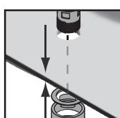
Per evitare fessure da tensione nella zona del raccordo e dello scarico, si raccomanda di utilizzare un materiale di tenuta appropriato (inserti in gomma o plastica) o un composto di tenuta permanente in plastica (kit di installazione per acqua calda e fredda). Assicurarsi che il materiale di fissaggio sia adatto al lavabo.
