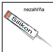
Umývadlo namontujte použitím sanitárneho silikónu v súlade s montážnym krokom. Je to z dôvodu bezpečnosti, vyrovnáva nerovnosti a pomáha predchádzať škodám spôsobeným vodou.
