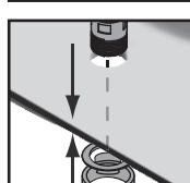
Aby uniknąć pęknięć naprężeniowych w obszarze armatury i odpływu, zaleca się zastosowanie odpowiedniego materiału uszczelniającego (wkładki gumowe lub z tworzywa sztucznego) lub trwałej plastycznej masy uszczelniającej z tworzywa sztucznego (zestaw montażowy do wody ciepłej i zimnej). Upewnić się, że materiał mocujący jest odpowiedni do zastosowania na umywalce.
