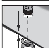
Aby uniknąć pęknięć naprężeniowych w obszarze armatury i odpływu, zaleca się zastosowanie odpowiedniego materiału uszczelniającego (wkładki gumowe lub z tworzywa sztucznego) lub trwale plastycznej masy uszczelniającej z tworzywa sztucznego (zestaw montażowy do wody ciepłej i zimnej). Upewnić się, że materiał mocujący jest odpowiedni do zastosowania na umywalcie.
