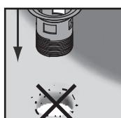
Dbajte na to, aby sa pri montáži odtokového ventilu nenachádzali na okraji otvoru žiadne nečistoty. Lokálne zvýšene napätie vyplývajúce z kontaktu s tvrdými materiálmi ako je kov môže rýchlo viesť k rozbitiu.
