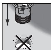
Durante l'installazione del calice di scarico, accertarsi che non vi sia sporcizia sul bordo del foro. I picchi di tensione locali dovuti al contatto con materiali duri come il metallo o il vetro possono portare rapidamente alla rottura.
