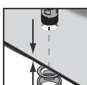
Odporučame použiť vhodný tesniaci materiál (gumené alebo plastové príložky), resp. trvalo plastický tesniaci tmel (inštalačná súprava pre horúcu a studenú vodu), aby sa predišlo vzniku trhlín spôsobených napätím v oblasti armatúry a odtoku. Dbajte na to, aby bol upevňovací materiál vhodný pre použitie na umývadle.
