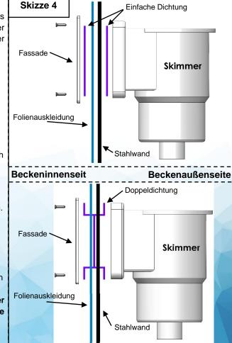
Zentimeter unterhalb des zu montierenden Teils befindet. Die Poolfolie muss durch den Wasserdruck gut gespannt sein.
