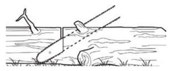
• Wenn der Baumstamm auf einer Seite gestützt liegt, machen Sie zuerst ein Einschnitt von unten in der Tiefe von ca. 1/3 des Baustammdurchmessers. Anschliessen sägen Sie den Stamm von oben bis zum unteren Einschnitt durch.
