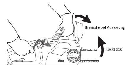
• Ziehen Sie den Rückstoss-Bremshebel nach hinten (A) und versuchen Sie die Säge zu starten. Die Säge sollte normal anlaufen. Drücken Sie den Bremshebel nach vorne (B) und versuchen Sie die Säge erneut zu starten. Die Säge darf nicht starten.
