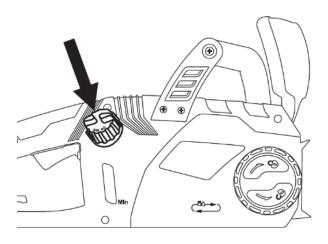
• Das Öl muss nachgefüllt werden, spätestens wenn der Ölstand auf der Öl-Füllstand-Anzeige das Minimum erreicht hat.
