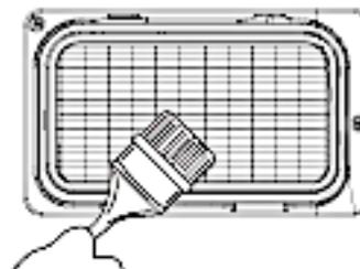
4. Reinstallieren Sie den Kondensator ordnungsgemäß und schließen Sie die Verriegelungen. **Der Kondensator muss vor der Reinstallation komplett trocken sein.**
