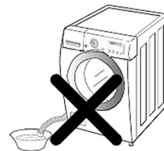
➤ Das Schlauchauslass des Wasserabflussschlauchs **darf nicht** in Wasser eingetaucht sein.
