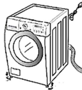
a. zum **Erhöhen** des Gerätes **nach links** drehen (s. Abb. rechts).
