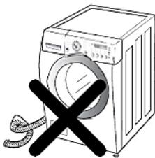
➤ Der Wasserabflussschlauch **darf nicht** verdreht sein.
