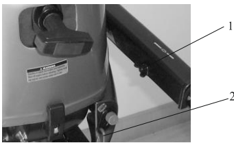
1-Tornillo fijación puño acelerador.2-Hombre al agua
