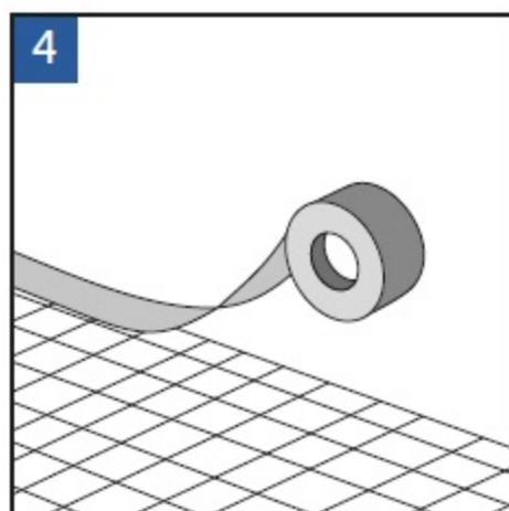
Um eine vollständige Hydroisolierung zu erzielen, kleben Sie die Unterlage mit Alu-Klebeband an die Wand. Alu-Klebeband ist als Zubehör erhältlich.
