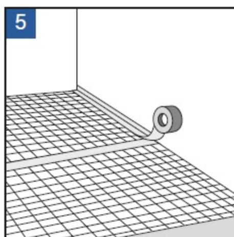
Die Unterlage muss an der Wand mit dem Alu-Klebeband verklebt werden, um eine vollständige Dampfbremse zu erreichen.
