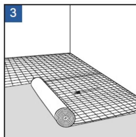
Die Unterlage wird auf dem sauberen und trockenen Unterboden mit der Dampfbremsfolie nach oben ausgerollt.
