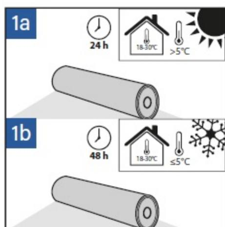
Die Unterlage sollte in dem Raum, in dem sie verlegt wird, akklimatisiert werden. 24 Stunden, wenn die Raumtemperatur 5 °C übersteigt, und 48 Stunden, wenn die Raumtemperatur unter 5 °C liegt.
