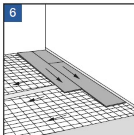
Verlegen Sie die Paneele quer zur Verlegerichtung der Unterlage, beachten Sie die Anleitung des Oberbodenherstellers.
