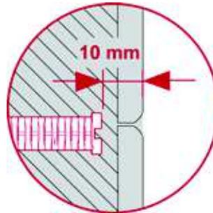
Drehen Sie beide Befestigungsstangen ein – Abstand der Befestigungsstange zur Wandoberfläche 10 mm.
