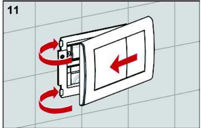
Haken Sie die Blende der TECEambia Betätigung rechts ein und installieren sie mittels Schnappverschlusses auf dem Befestigungsrahmen.
