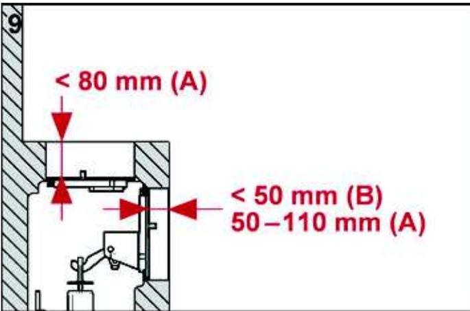
Die Befestigungsstangen entsprechend des Wandaufbaus abknicken.
