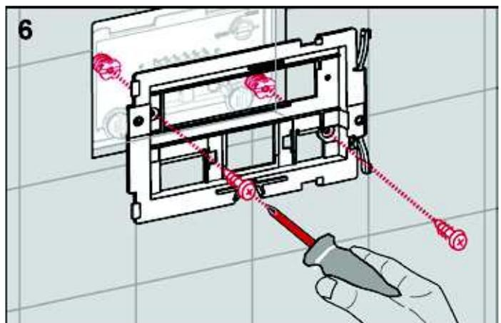
Montieren Sie den Befestigungsrahmen an den Befestigungsstangen.
