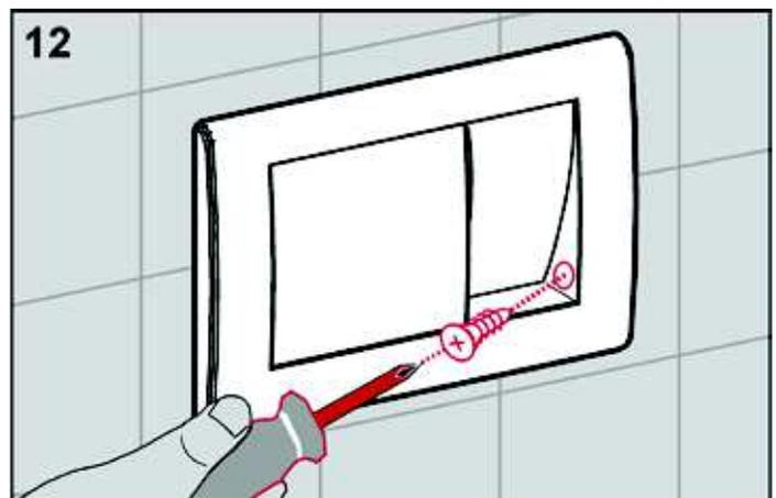
Die Schraube der Vandalensicherung abschließend in die Innenseite der Betätigungsplatte eindrehen (Vorsicht: Oberfläche nicht beschädigen).
