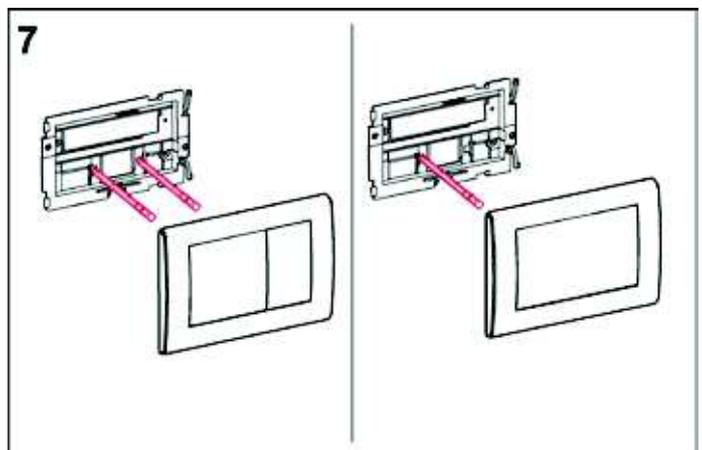
Bei Zweimengentechnik werden zwei Betätigungsstangen (rot und grau) installiert, bei Einmengentechnik nur eine (grau).
