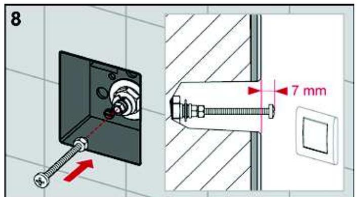
Drehen Sie die Betätigungsstange wie vorgeschrieben ein (bei TECEplanus 7 mm Abstand zur Wandoberfläche) und sichern Sie sie mit der Kontermutter gegen das Verdrehen.
