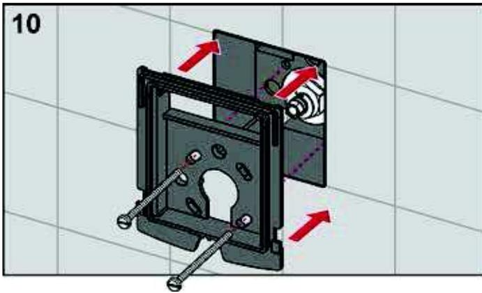
Schrauben Sie den Befestigungsrahmen an das Urinalspülergehäuse.
