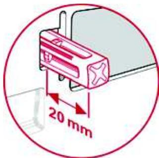
Drehen Sie beide Betätigungsstangen ein – Abstand zur Vorderkante des Befestigungsrahmens 20 mm.
