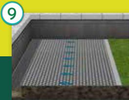
9 La malla de drenaje filtrará el agua hacia el desagüe
