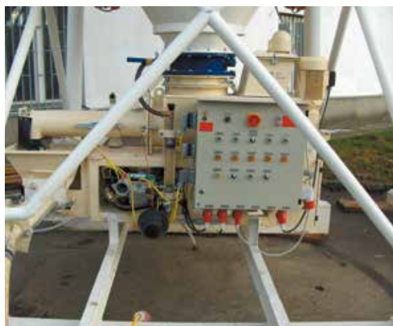
Abbildung 25: Schneckenpumpe - Ferro für CSFE
