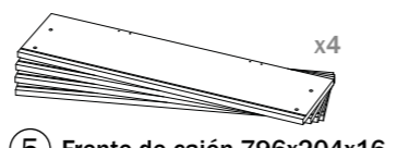
5 Frente de cajón 796x204x16 Frente da Gaveta - Drawer - Front du tiroir
