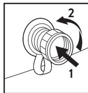
b) Drücken und drehen Sie den Ablauf gegen den Uhrzeigersinn für etwa eine Vierteldrehung (90°), um sie zu verriegeln.
