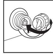
c) Drehen Sie die Ablasskappe um und setzen Sie sie wieder in das Ablassventil ein.
