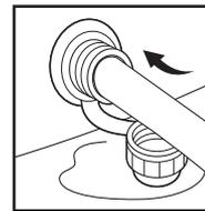
f) Schließen Sie einen 5/8-Zoll-Gartenschlauch an das Ablassventil an.
