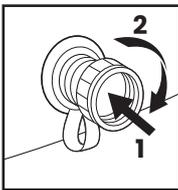
d) Drücken und drehen Sie den Ablassdeckel zum Entriegeln etwa eine Vierteldrehung (90°) im Uhrzeigersinn.
