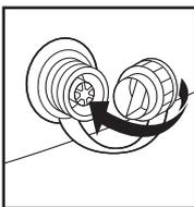
a) Drehen Sie die Ablasskappe um und setzen Sie sie wieder in das Ablassventil ein.
