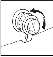
a) Drehen Sie die Ablasskappe gegen den Uhrzeigersinn.
