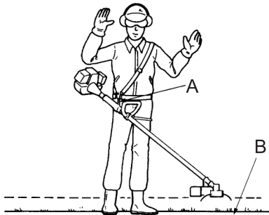
Orodje uravnotežite za izravnano vrtenje rezalne glave
