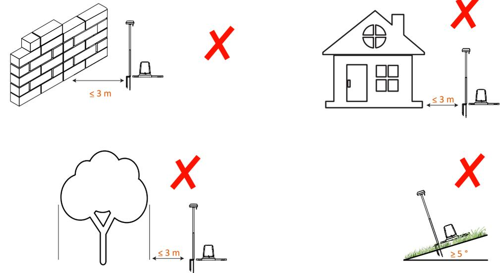
Wenn kein geeigneter Standort auf dem Boden vorhanden ist, muss der Benutzer die Verwendung des zusätzlichen Zubehörsatzes in Betracht ziehen, um die Referenzstation auf dem Dach zu installieren (der zusätzliche Satz ist separat erhältlich). Wenn Sie die Referenzstation auf dem Dach installieren, stellen Sie bitte sicher, dass die Station nach oben gerichtet bleibt und nicht blockiert wird, damit die Antenne einen Freiraum von mehr als  $110^\circ$  hat.
