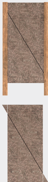
Lichter Sparrenabstand < 59 cm erforderliches Übermaß 1-1,5 cm
