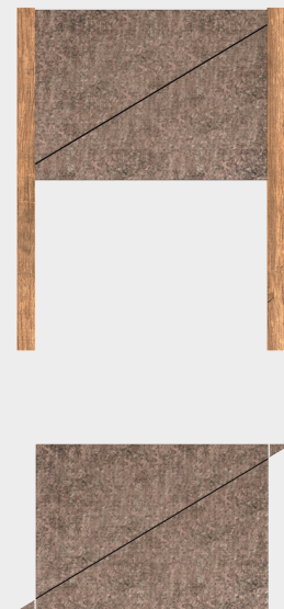
Lichter Sparrenabstand 60-90 cm erforderliches Übermaß 1-2 cm
