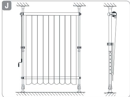
**HINWEIS:** Stellen Sie sicher, dass der Stoff der Markise 1 immer vollständig eingerollt ist, damit sich die Markise 1 nicht selbst entrollt. Der Stoff der Markise 1 muss straff eingespannt werden. Andernfalls kann es zu Beschädigungen der Markise kommen. Die Handkurbel 6 hat keine Stoppvorrichtung, die vor Überdrehung schützt.
