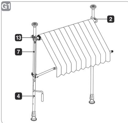
Markisen-Gestell-Höhe: Lösen Sie die Schraube **16** des Feststellelementes **5** und verschieben Sie die untere Stütze **4** innerhalb der oberen Stütze (Abb. G1).
