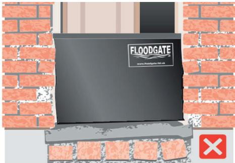
Um eine effektive Abdichtung zu gewährleisten, müssen sich die Wände lotgerecht, parallel zueinander und im rechten Winkel zu einer ebenen Stufe/zum Untergrund befinden. Die Wände müssen ausreichend stabil sein, um dem von der Barriere ausgeübten Seitendruck standzuhalten.
