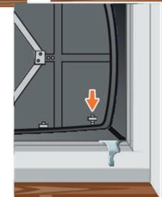
Ggf. müssen die Schrauben nachgestellt werden, z. B. wenn Wasser durchsickert. Stellen Sie dazu die dem Wasser nächstliegende Schraube ein.
