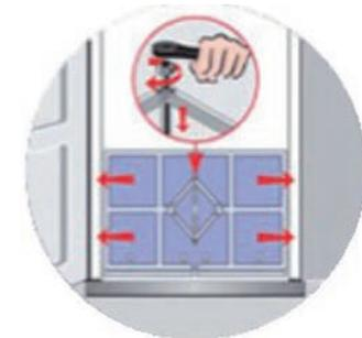
Horizontale Verspreizung der Floodgate Türsperre durch Drehen einer Spindel mit einem mitgelieferten Ring-Ratschenschlüssel
