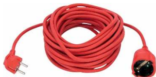
15m H05VV-F 3G1,5mm², rot Schutzkontaktstecker+Kupplung 16A IP20 – Zur Verwendung in trockenen Räumen
