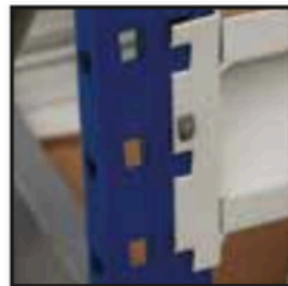
Längsträgerbefestigung und Verstärkungsstifte
