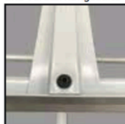
Befestigung des Querträgers und Verstärkung
