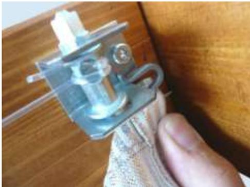
Die beiden Gewebehaken am Ende der Sonnensegel (kleine Schlaufe) zum Drahtspanner führen und einhängen
