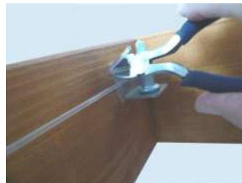
Entfernen sie das überstehende Ende vom Polyesterdraht am Drahtspanner
