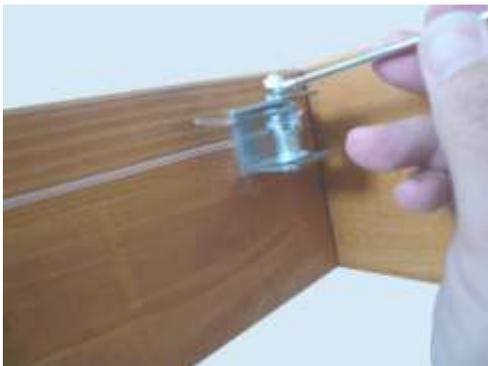
den 7er Maulschlüssel auf den Vierkant am Drahtspanner ansetzen und den Polyesterdraht mit ca. 2-3 Umdrehungen straff spannen. **Achten sie darauf, daß der Draht dicht nebeneinander in Richtung Drahtspannermitte und nicht**
