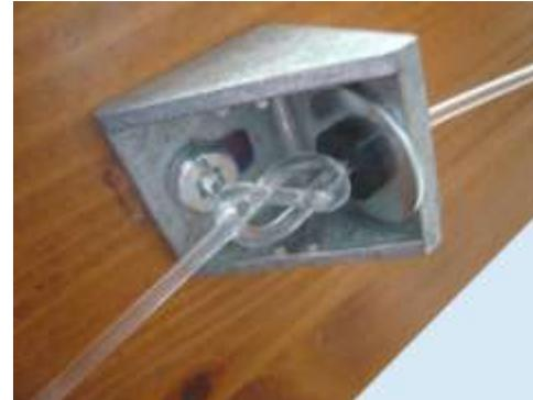
Ansicht vom fertig verknöteten Polyesterdraht. Den Knoten vorher unbedingt auf ca. 1,5 - 2 cm zusammenziehen. Die Kunststofffülle muß in die Unterlegscheibe eingeführt werden
