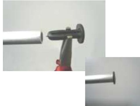
Stecken sie jeweils an einer Seite von jedem 8 mm Alu-Rohr mit Hilfe einer Spitzzange die Kunststoff-Endkappen ein. Alternativ können die Endkappen auch mit einem kleinen Hammer eingeschlagen werden
