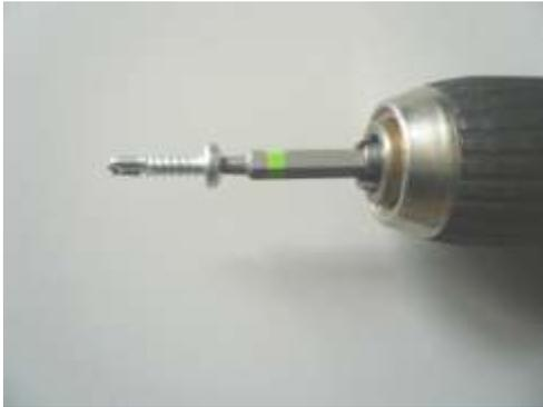
Benutzen sie für die Montage in Metallsparren die selbstbohrenden Blechschrauben. Alternativ können sie auch mit 4 mm vorbohren und die Schraube von Hand eindrehen
