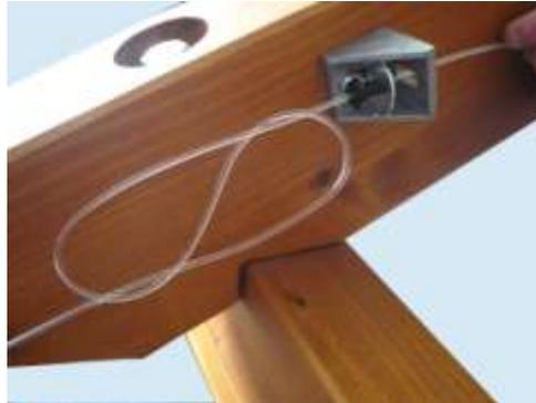
verknöten sie den Polyesterdraht mit einem Achterknoten. Verwenden sie bitte keinen anderen Knoten, da sonst ein sicherer Halt nicht garantiert werden kann. **!Beschreibung ab Bild 29!**
