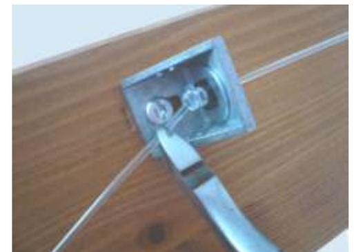
schneiden sie am Drahthalter den Polyesterdraht ca. 1,5 cm vom Knoten entfernt ab. Sollte das Drahtende nach oben stehen, drehen sie es einfach in den Drahthalter ein
