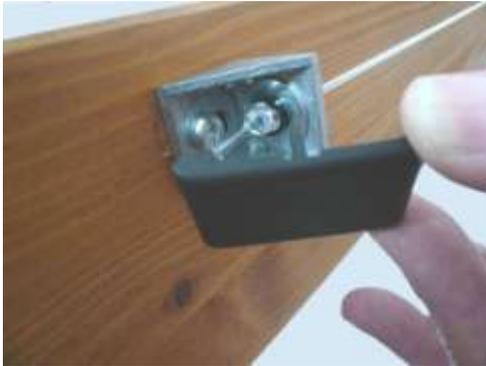
setzen sie anschließend die Kunststoffkappe auf den Drahthalter und drücken diese fest an
