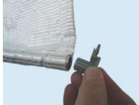
setzen sie den Federclip an beiden Enden vom 19 mm Alu-Rohr ein
