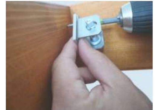
Drahtspanner und Distanzplatte anschrauben. Nachdem die Bohrspitze das Aluminium durchdrungen hat, greift das Schraubengewinde.
