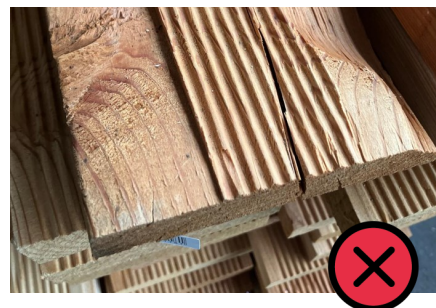
Hobelfehler >15mm auf der Sichtseite nicht erlaubt
