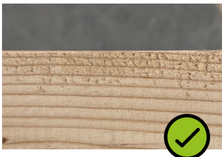
Hobelfehler auf der Rückseite erlaubt
