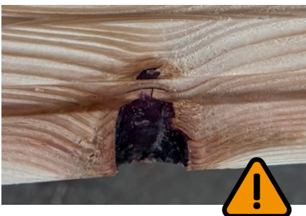
Kantenausbruchäste - vereinzelt einseitig zulässig
