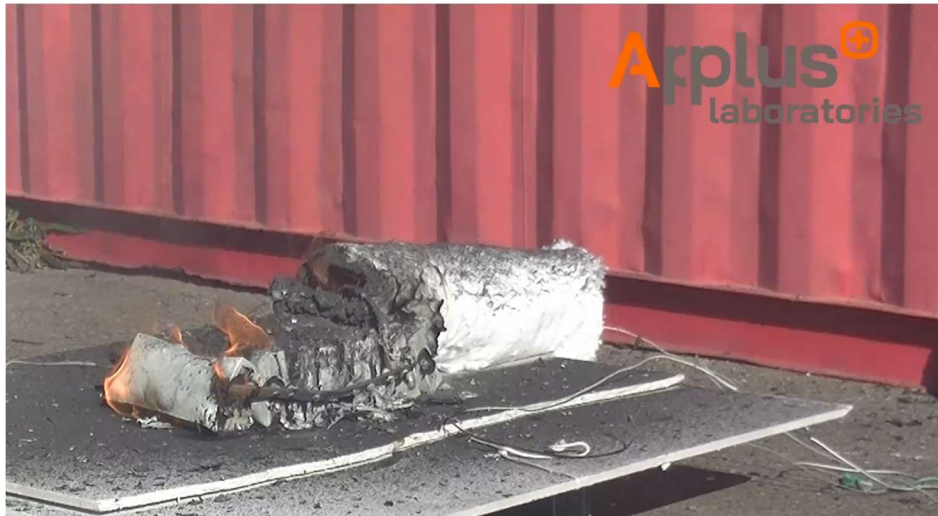
Figura 15: Estado de la batería después del ensayo 0.
