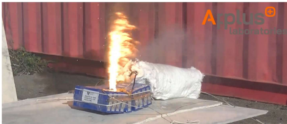
Figura 13: Batería en reacción ensayo 0.
