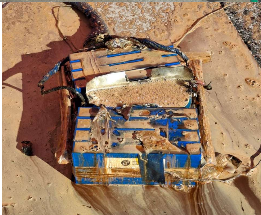
Figura 19: Estado de la batería después del ensayo 1.
