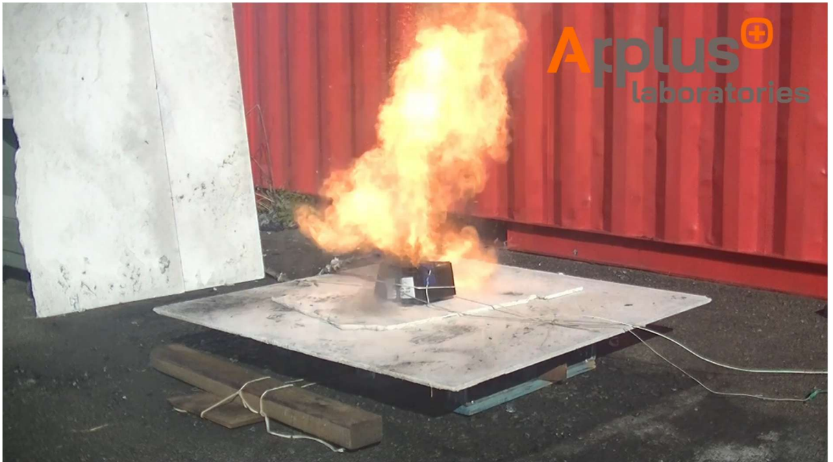
Figura 21: Batería en reacción ensayo 3.
