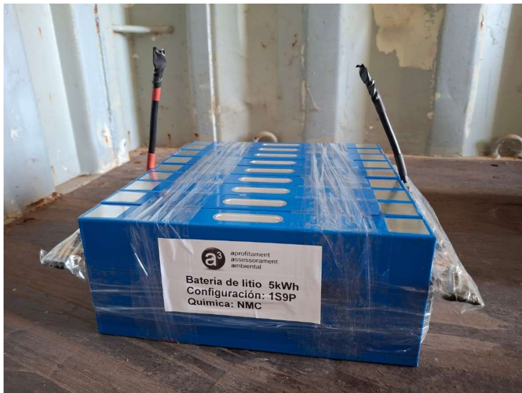
Figura 11: Batería de 5kWh para el ensayo del extintor de 40L.
