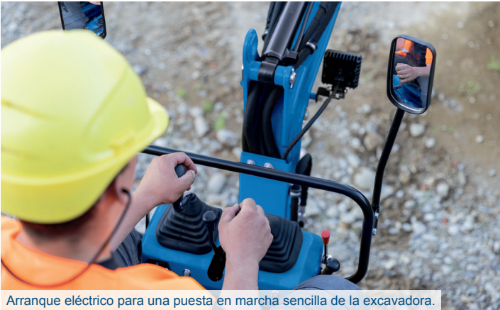
Arranque eléctrico para una puesta en marcha sencilla de la excavadora.
