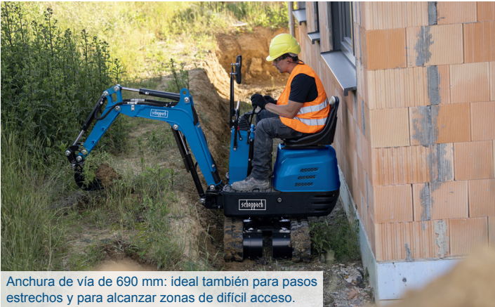
Gracias a un elevado alcance máximo de excavación de 2330 mm, también pueden realizarse de forma óptima trabajos en taludes o pendientes.
