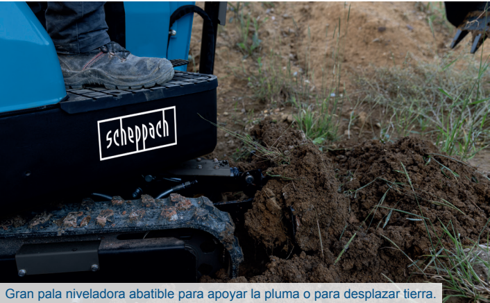
Gran pala niveladora abatible para apoyar la pluma o para desplazar tierra.
