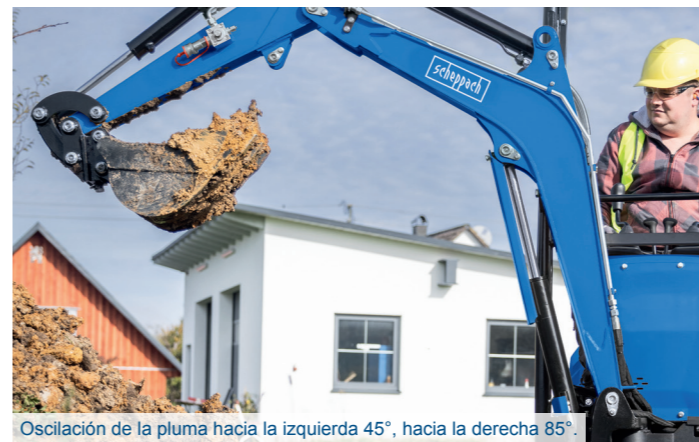
Oscilación de la pluma hacia la izquierda 45°, hacia la derecha 85°.
