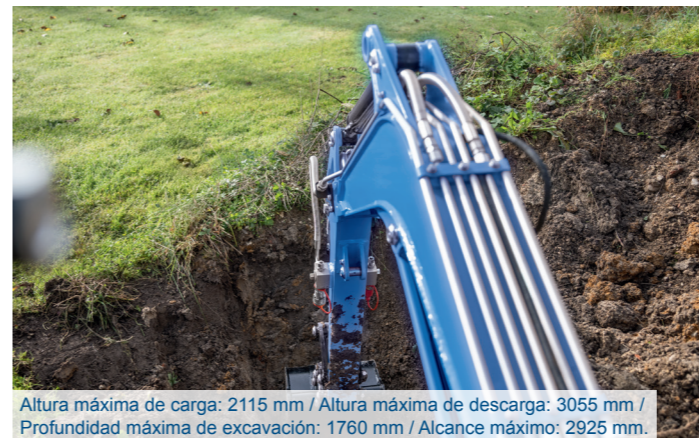
Equipada de serie con una cuchara de 350 mm de ancho y 0,022 m 3 de capacidad.
