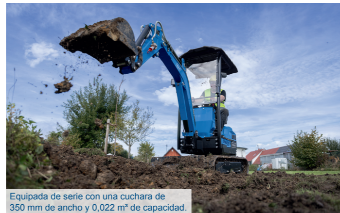
Oscilación de la pluma hacia la izquierda 45°, hacia la derecha 85°.
