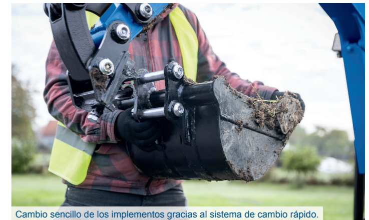
Cambio sencillo de los implementos gracias al sistema de cambio rápido.
