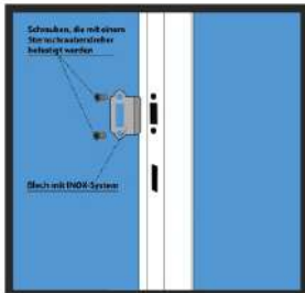
MONTAGE DES BLECHES MIT INOX-SYSTEM
