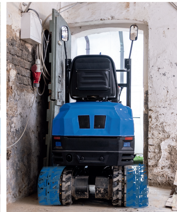
Ausfahrbares Fahrwerk von 720 bis 900 mm für flexible Anpassung an Engstellen oder stabilen Stand beim Baggerbetrieb.
