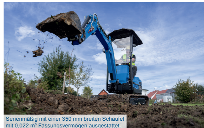
Schwenkbereich Ausleger nach links 45°, nach rechts 85°.
