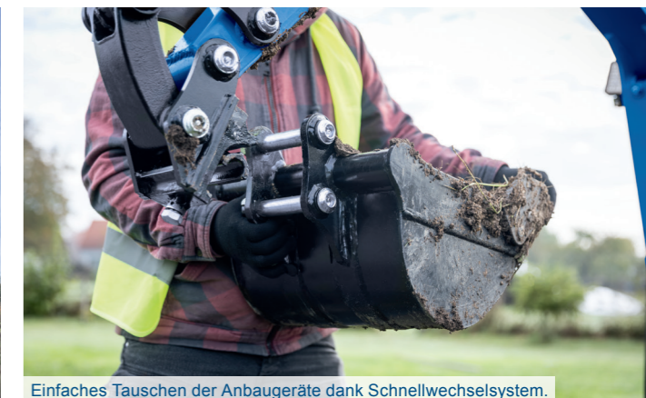
Einfaches Tauschen der Anbaugeräte dank Schnellwechselsystem.
