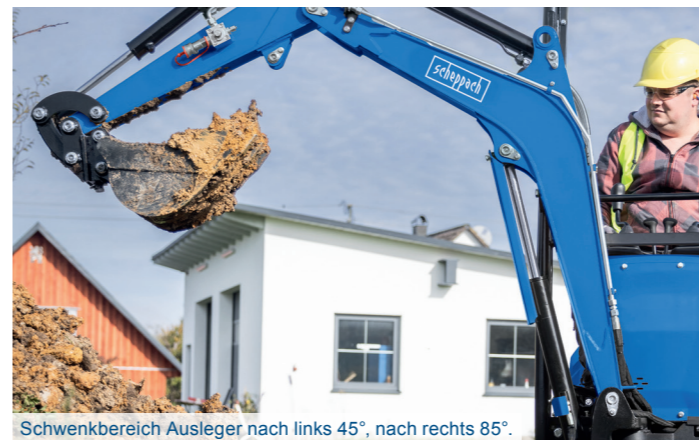
Schwenkbereich Ausleger nach links 45°, nach rechts 85°.
