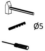
Mit Ø5 Bohrer durchbohren
