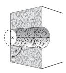
Beachten Sie, dass die Kernbohrung mit einem leichten Gefälle nach Außen ausgeführt wird.
