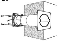
Das Kabel des Klappenmotors ins Innere führen und den Klappenmotor in den äußeren Flansch einrasten. Dabei darauf achten, dass die Markierung nach oben gerichtet ist.
