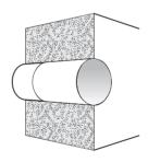
Das Teleskoprohr mit dem größeren Durchmesser nach Außen in die Bohrung einpassen, mit leichtem Gefälle nach Außen einschäumen und ggfls. passend ablängen.
