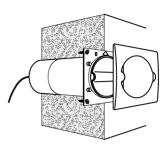
Den äußeren Flansch in das Teleskoprohr einschieben und mit vier Schrauben an der Wand befestigen. Dabei darauf achten, dass die \_\_\_\_\_Markierung nach oben gerichtet ist. Die äußere Abdeckung auf den äußeren Flansch einrasten. Dabei darauf achten, dass die .—Markierung nach oben gerichtet ist.
