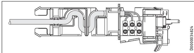
► Legen Sie das Anschlusskabel in die Führung.
