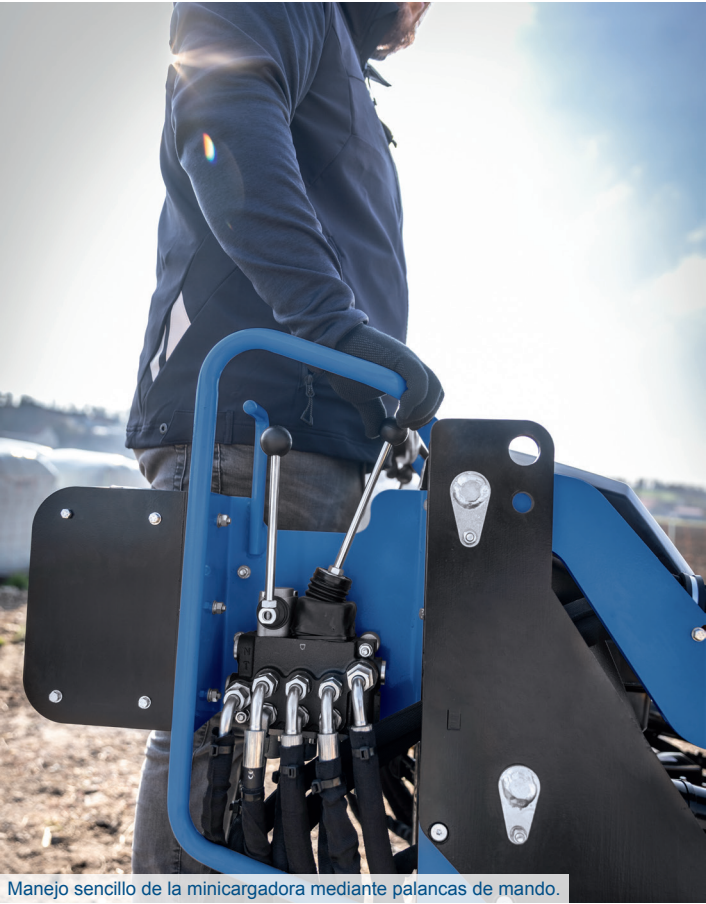
Manejo sencillo de la minicargadora mediante palancas de mando.
